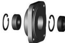
6. Sicherungsringe lösen und Lager bzw. Wellendichtring auspressen.
