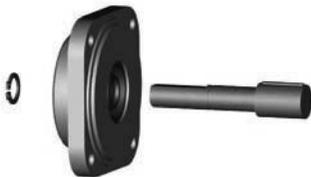
5. Sicherungsring lösen und Welle auspressen.
