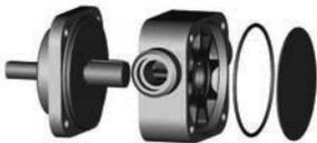
3. Seitenscheibe ohne Loch und Gehäuse mit Impeller abziehen.
